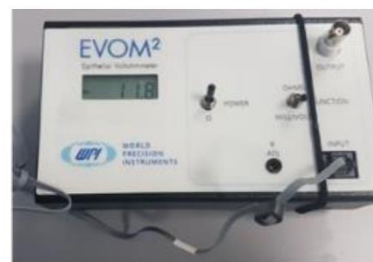
Voltohmmetru folosit pentru evaluarea rezistenței electrice trans-epiteliale
